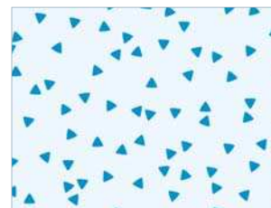
Kristallite aus zirkonoxidverstärktem Lithiumsilikat (ZLS) 500-1400 nm
