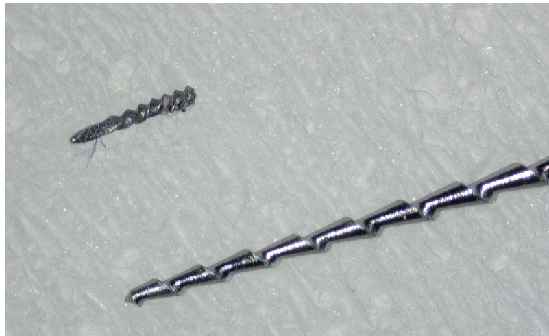
Abb. 6: Separierte Ultraschallschallspitze im Vergleich mit einer Hedström-Feile ISO 10.
