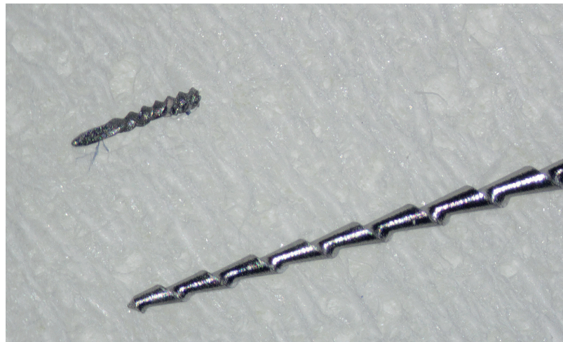
Abb. 6: Separierte Ultraschallspitze im Vergleich mit einer Hedström-Feile ISO 10.
