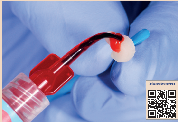
Aufgrund des dominierenden Feldspatkeramiknetzwerks kann VITA ENAMIC ST mit Flusssäure geätzt werden.
