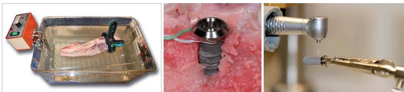
Abb. 2: Versuchsaufbau: Präparat wird konstant auf Körpertemperatur gehalten. – Abb. 3: Versuchsaufbau: digitale Temperaturmessung, Umschlingung des Implantatkopfes mit K-Typ-Thermoelement. – Abb. 4: Versuchsaufbau: simulierte Periimplantitisbehandlung im zahn-technischen Stativ.
