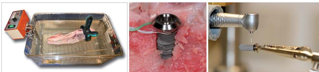
**Abb. 2:** Versuchsaufbau: Präparat wird konstant auf Körpertemperatur gehalten. – **Abb. 3:** Versuchsaufbau: digitale Temperaturmessung, Umschlingung des Implantatkopfes mit K-Typ-Thermoelement. – **Abb. 4:** Versuchsaufbau: simulierte Periimplantitisbehandlung im zahn-technischen Stativ.
