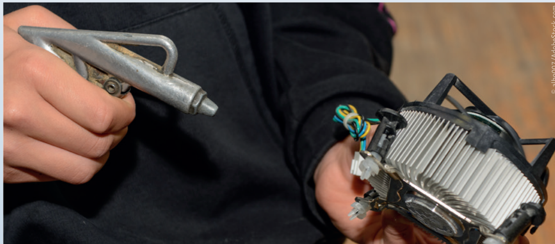
Eine Reinigung der einzelnen Komponenten mit Druckluft durch einen Fachmann entfernt auch schwer zugängliche Verunreinigungen.
