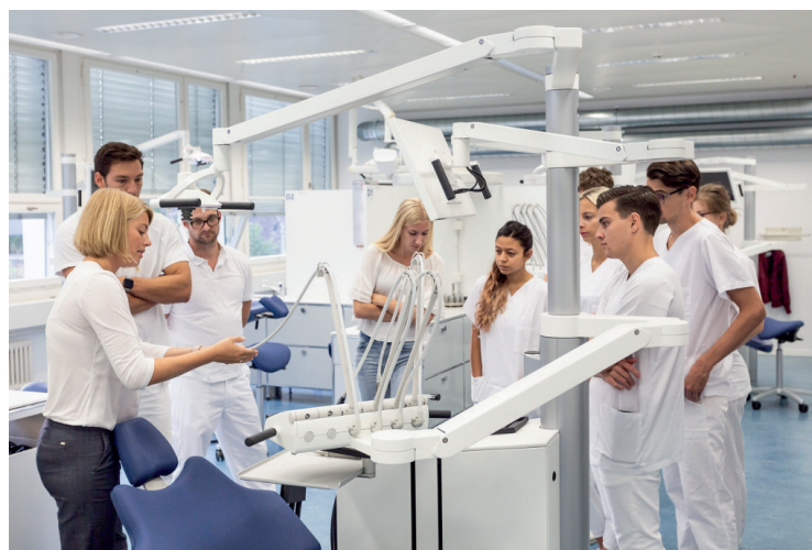
Durch die ausbalancierte Aufhängung der Instrumente tritt selbst bei Seitenbewegungen kein Gegenzug an den Schläuchen auf. (© XO CARE)
