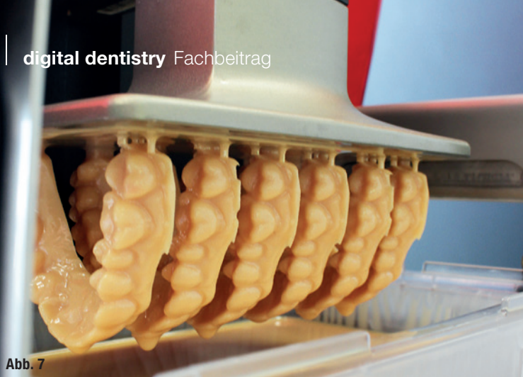
Abb. 7 und 8: Beispielhafte Darstellung: Modelldruck im 3D-Drucker Asiga (dentona) mit entsprechendem Druckermaterial (hier: optiprint model, dentona) und das gedruckte Modell im Tiefziehgerät. Abb. 9: Beispielhafte Darstellung: optilign-Set mit drei Modellen (je Sequenz eins) und jeweils drei zugehörigen Schienen.
