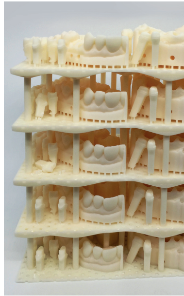
Abb. 5: Die ASIGA-Drucker bei ZAHNWERK Frästechnik (Solingen) verarbeiten härtende Photopolymere.
