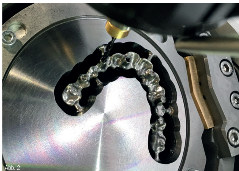
Abb. 1: DCS-Systeme mit WorkNC in der Endabnahme. Abb. 2: Implantatgetragene Suprakonstruktionen im DC7 System.
