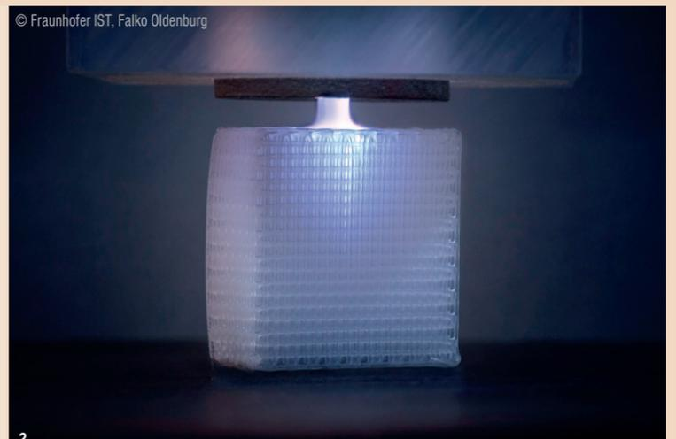
Abb. 2: Beschichtung von Gerüststrukturen für Implantate mit einem Plasma-Jet.
