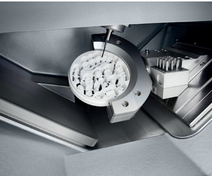
Abb. 3: Nass schleifen oder trocken fräsen – die R5 erledigt beides ohne aufwendige Umrüstarbeiten. So können alle denkbaren Indikationen auf einer Maschine realisiert werden.
