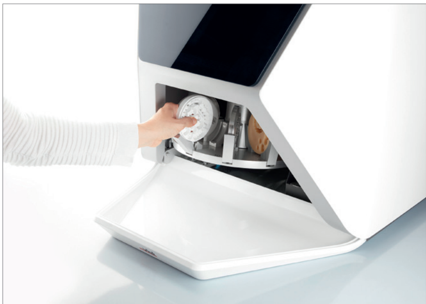
Abb. 1: R5 – eine hochautomatisierte Fräs- und Schleifmaschine für Nass- und Trockenbearbeitung in der Dentaltechnik. Abb. 2: Der automatische Rondenwechsler wird werkzeuglos bestückt – eine Sache von Sekunden. Danach bearbeitet die Maschine bis zu zehn Rohlinge je nach Bedarf.
