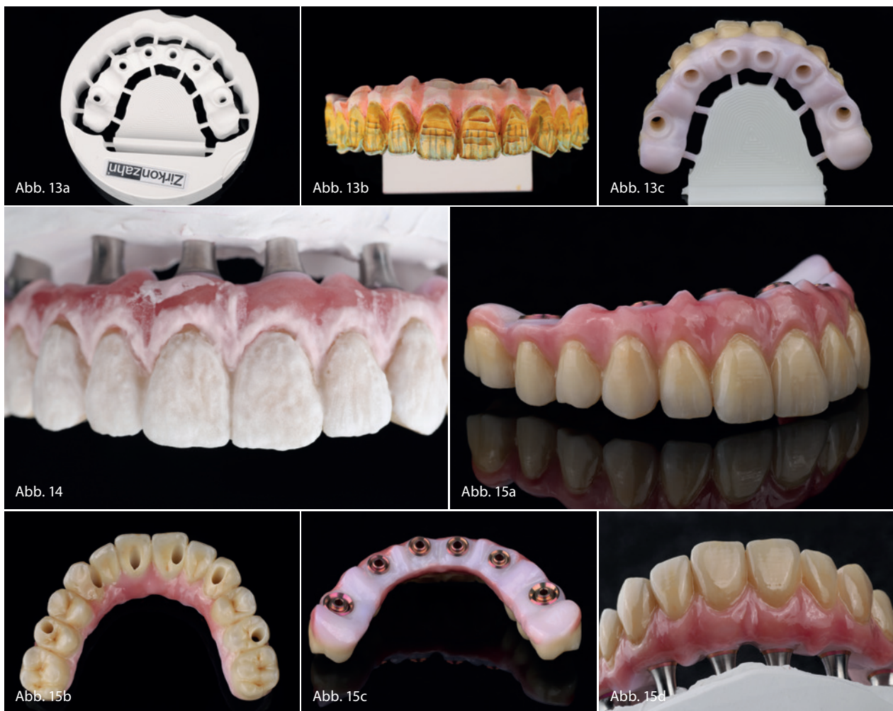
Abb. 13a: In Zirkon gefräste Zirkonstruktur. Abb. 13b: Individuell eingefärbtes Zirkongerüst. Abb. 13c: Fertig gesinterte Zirkonbrücke. Abb. 14: Individuelles Verblenden der Zirkonbrücke. Abb. 15a–d: Fertig verblendete und mit Titanbasen verklebte Implantatbrücke.
