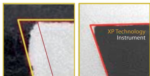
Um die ursprüngliche Kante wieder zu erlangen, müsste das Instrument an der ROTEN Linie aufgeschliffen werden.
