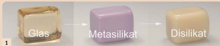
Abb. 1: Lithium-Disilikat-Keramikblöcke zeichnen sich durch ihre hohe Biegefestigkeit aus (Darstellung der drei verschiedenen Kristallisationsstufen).
