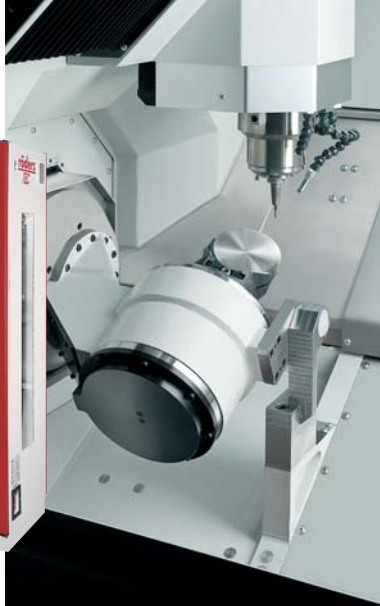
Oben: Die RXP 500 DS Hochgeschwindigkeitsfräsmaschine. – Rechts: Innenraum der RXP 500 DS.
