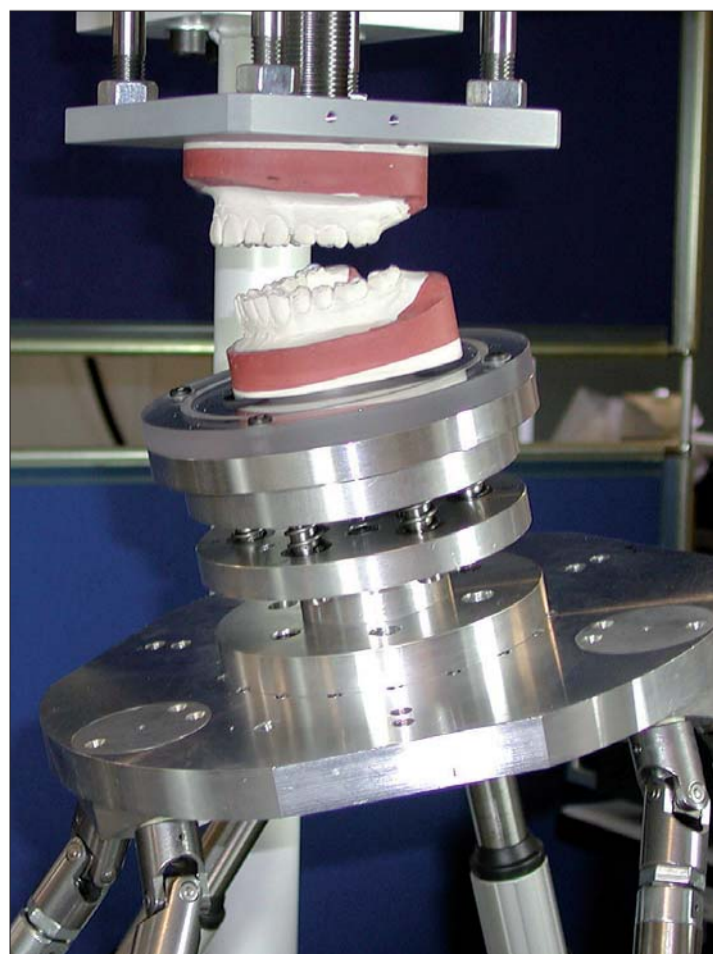
Abb. 3: Der bewegliche Unterkiefer verfügt über sechs Freiheitsgrade und kann so alle Bewegungen nachahmen, die ein menschlicher Unterkiefer während des Kauvorgangs aufweist.
