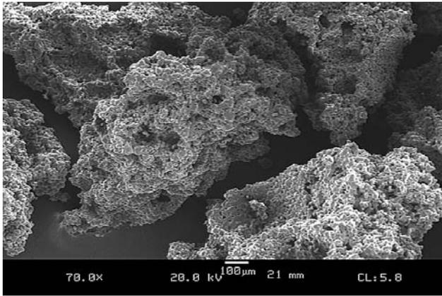
**Abb. 1:** Elektronenmikroskopische Aufnahme von Cerasorb M®-Granula, 70-fache Vergrößerung.
