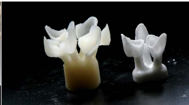
Abb. 6: Transluzente und opake Gerüste nach dem Pressvorgang.
