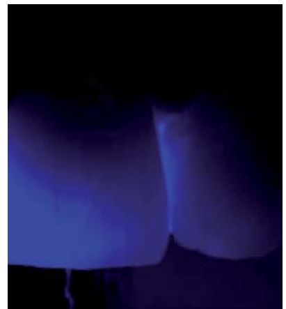
Abb. 10: Gleichmäßige Lichtstreuung bei den transluzenten Gerüsten.
