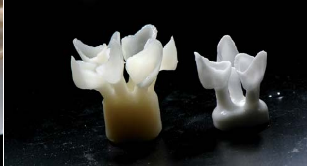
Abb. 6: Transluzente und opake Gerüste nach dem Pressvorgang.
