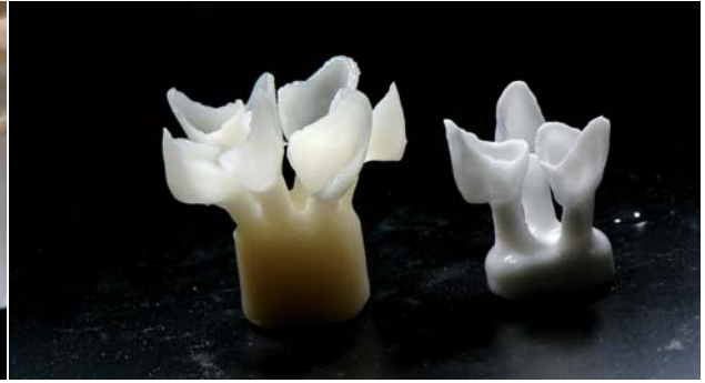
Abb. 6: Transluzente und opake Gerüste nach dem Pressvorgang.
