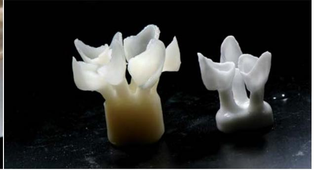
Abb. 6: Transluzente und opake Gerüste nach dem Pressvorgang.
