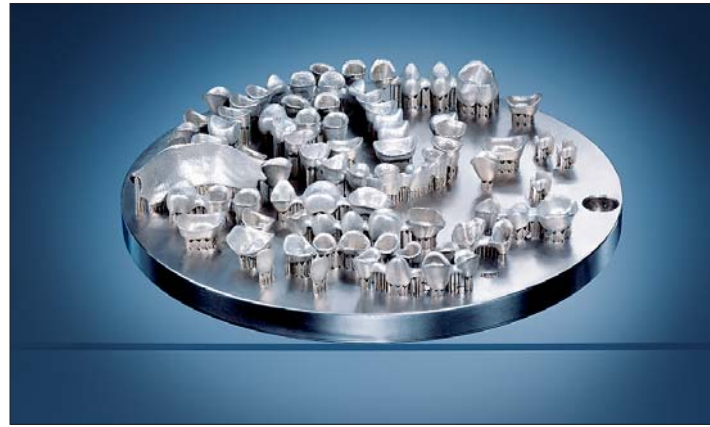
Mit der neuen Lasersinterernteinheit Hint-ELs® rapid Pro 250 können bis zu 100 Einheiten in nur vier Stunden produziert werden.
