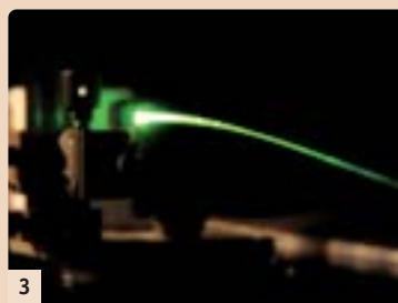
Abb. 3: Biosilica-Glasnadeln aus Schwämmen sind lichtleitend (hier: Pfahlnadel des Tiefsee-Glasschwamms Monorhaphis chuni ). – Abb. 4: Gute Bindeeigenschaften des auf Biosilica basierenden osteoinduktiven Kompositmaterials (Autofluoreszenz).
