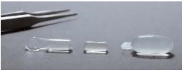
osmed Gewebeexpander Cylinder Dental im ungequollenen Zustand (links), ohne Silikonhülle (Mitte) und nach Quellung (rechts).
