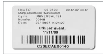
▲ Abb. 3: Das Etikett gibt Aufschluss über den Benutzer, der das Sterilgut freigegeben hat, die Nummer des Sterilisators, die Chargennummer, das Datum der Sterilisation und die Lagerfrist des Sterilgutes.
