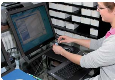
Die Prozessdokumentation wird auf dem speziellen USB-Stick abgelegt und von dort in den Computer eingelesen und digital gespeichert. (Foto: Miele)
