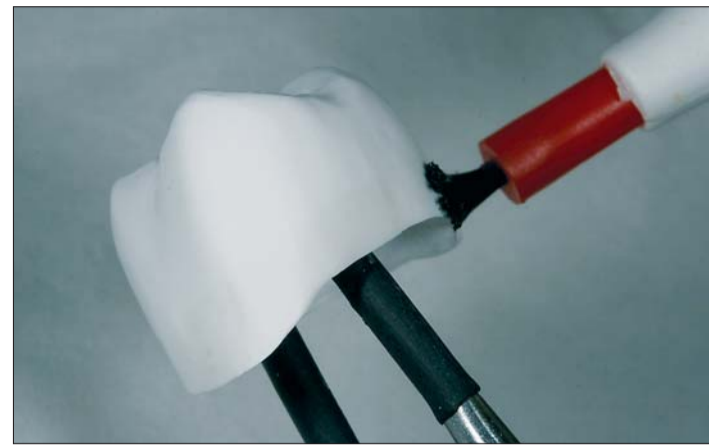
Zervikale zirkuläre Einfärbung wird mittels ZENOSTAR Pinseltechnik vorgenommen.
