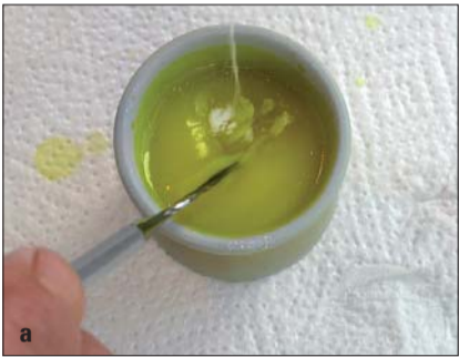
Abb. 8a-c: Anrühren (a) und Auftragen des Kunststoffes (b, c).
