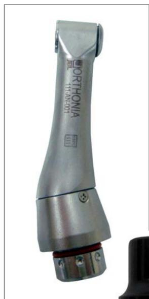
zudem maximale Sicherheit. Die Drehmomente lassen sich exakt auf die jeweilige Schraubenstärke einstellen (d. h. für Schrauben 1,4 mm/15 N-cm, 1,6 mm/20 N-cm, 2,0 mm/30 N-cm). Drei wählbare Geschwindigkeiten (10, 15 und 20 RPM) sorgen für sehr langsame, kontrollierte und knochen-schonende Insertionen, so dass eine Erhitzung von Gewebe somit praktisch ausgeschlossen ist. Ein Rechts-Links-Lauf ermöglicht des Weiteren die leichte, patientenfreundliche Entfernung der Minischrauben.
