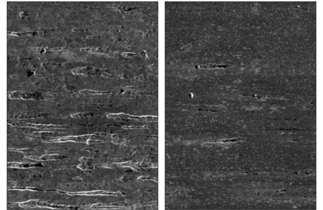
Im Vergleich zum unvergüteten  $\beta$ -Titan-Draht (links) konnte aufgrund des neu entwickelten Veredelungsprozesses die Oberflächenrauheit des LoFrix- $\beta$ -Titan-Drahtes (rechts) deutlich sichtbar reduziert werden (500-fache mikroskopische Vergrößerung). (Quelle: Oralmedizinische Technologie, Universität Bonn)
