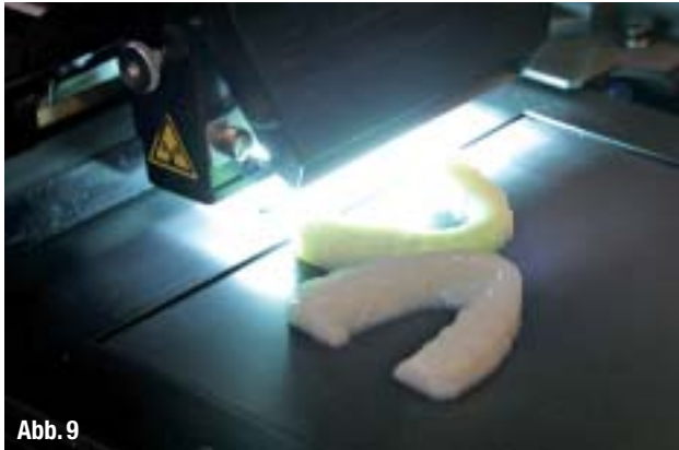
▲ Abb. 9: 3-D-Kunststoffdrucker. ▲ Abb. 10: DVT-Volumen in Kunststoff ausgedruckt.
