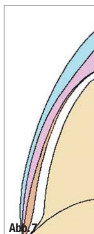
▲ Abb. 6: ... und von palatinal. ▲ Abb. 7: Brandführung: Eine gleichmäßige Wärmeleitung zwischen dem ZrO_2Y_2O_3 -Gerüst und der Verblendkeramik ist nur bei max. 50 °C/min. gewährleistet.
