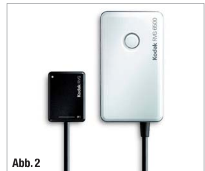
▲ Abb. 2: Das Endprodukt: Der Sensor Kodak RVG 6500.
