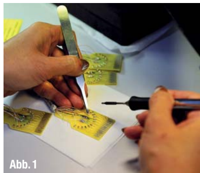
▲ Abb. 1: Ein Großteil bei der Herstellung der Röntgensensoren Kodak RVG 6500 ist Handarbeit.
