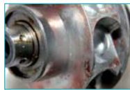
▲ Vorher – Das Bild zeigt eine Turbine, die mit einer Testanschmutzung nach DIN ISO/TS 15883-5 durch ein Institut verunreinigt wurde.
