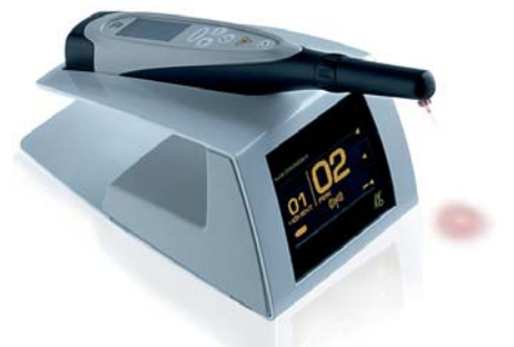
Abb. 2: Karieserkennung mit dem DIAGNOdent pen von KaVo.
