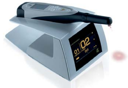
Abb. 2: Karieserkennung mit dem DIAGNOdent pen von KaVo.
