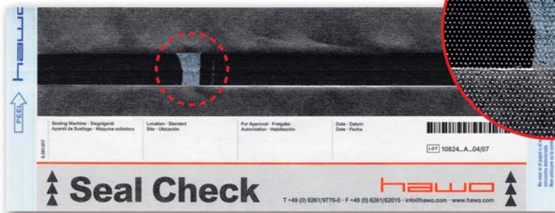
Abb. 3: SEAL CHECK mit Lupe: Fehlerhafte Siegelnähte können klar identifiziert werden (hier: Kanalbildung in Siegelnaht).
