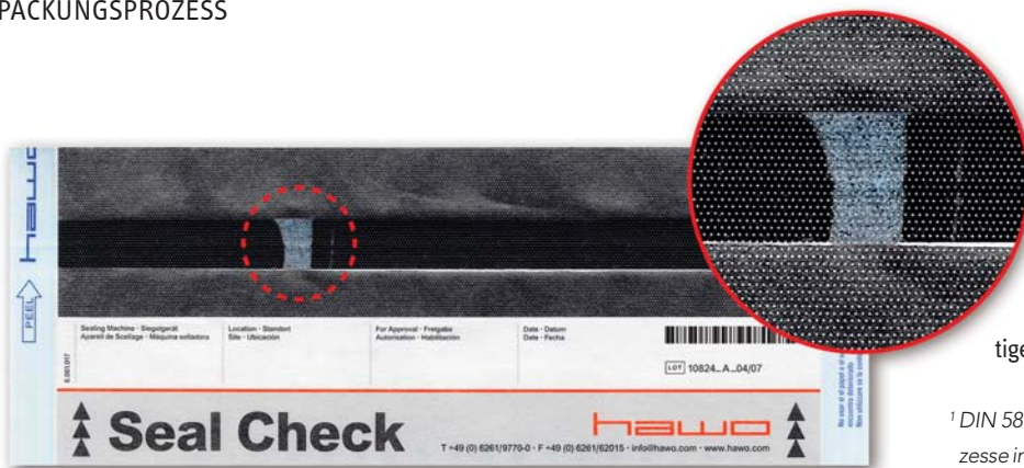
Abb. 3: SEAL CHECK mit Lupe: Fehlerhafte Siegelnähte können klar identifiziert werden (hier: Kanalbildung in Siegelnaht).
