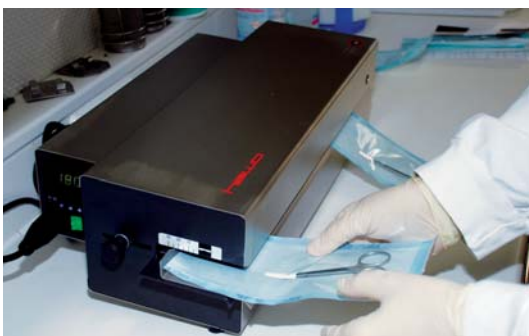
Abb. 2: Einlegen der Verpackungen in ein normkonformes Durchlaufsiegelgerät (hier hawo hd 680 DE-V).
