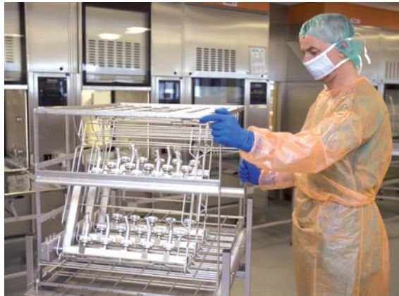
Beladungswagen mit den neuen Kassetteneinsätzen, von denen jeweils sechs pro Wagen genutzt werden können. Jeder Einsatz ist mit je zehn Injektoranschlüssen für Dental-Instrumentarium ausgestattet. Außerdem bietet der Wagen noch Platz für Siebschalen, zum Beispiel mit zahnärztlichem Zubehör wie Sonden und Mundspiegeln. (Fotos: Miele)
