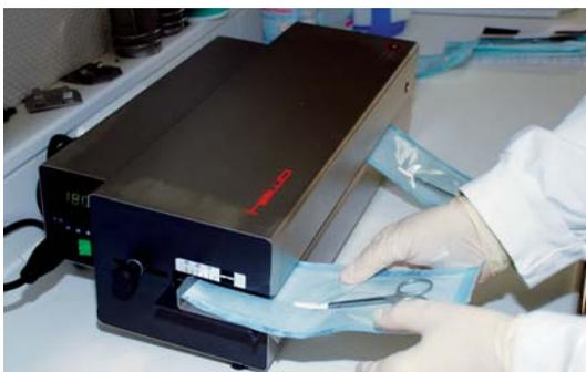
Abb. 2: Einlegen der Verpackungen in ein normkonformes Durchlaufsigelgerät (hier hawo hd 680 DE-V).
