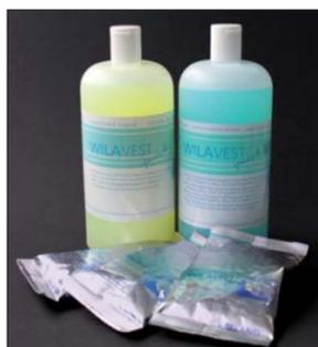
Eine Einbettmasse und zwei Flüssigkeiten, die durch Farbcodierung klar unterschieden werden können.
