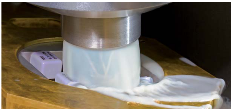
Schwallkühlung für die Nassbearbeitung.
