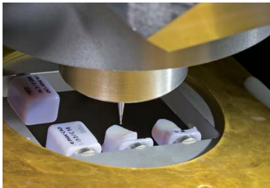
Spannaufnahme für Glaskeramik-Blöcke.
