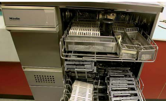
Reinigungs- und Desinfektionsautomaten bieten die sicherste und zuverlässigste Option zur Dekontamination und Desinfektion. Tablettensysteme müssen ermöglichen, dass Wasserstrahlen jeden Teil der Instrumente erreichen, um wirksam zu reinigen und Keime unschädlich zu machen.
