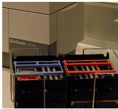
Im Fall der Ultraschallreinigung werden Instrumente am besten gereinigt, wenn die Instrumente befestigt, aber frei zugänglich sind und die Befestigungsvorrichtung nicht berühren.
