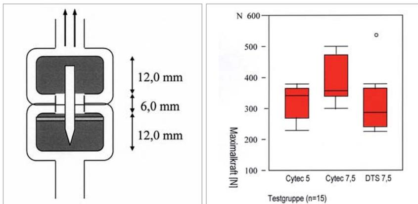
Abb. 3: Versuchsaufbau. – Abb. 4: Box-Plot-Diagramm der ermittelten Zugkräfte.
