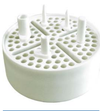
Der Objektträger besitzt mehr als 100 Bohrungen.
