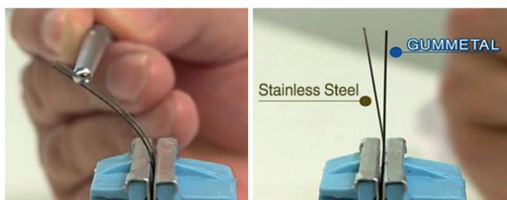
GUMMETAL® ermöglicht die stabile Drahtbiegung und besitzt gleichzeitig hervorragende Rückfederungseigenschaften. (© J. MORITA EUROPE GMBH)
