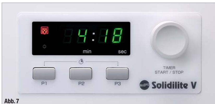
▲ Abb. 7: Über den aktuellen Betriebszustand informieren ein Betriebsstundenzähler sowie eine Warnleuchte, falls einer der vier Halogenstrahler nicht betriebsbereit ist.
