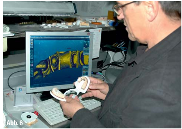
▲ Abb. 5: Konstruktion der Brücke. ▲ Abb. 6: Zahntechniker Franz Noll vergleicht das angelieferte SLA-Modell mit der Konstruktion.
