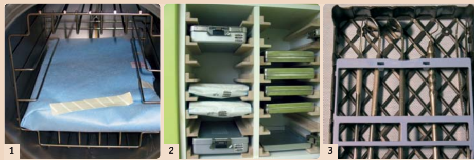
Abb. 1: Instrumententray in Fliesverpackung. – Abb. 2: Lagerschrank für nächste Behandlung. – Abb. 3: Grund- und Untersuchungstray.
