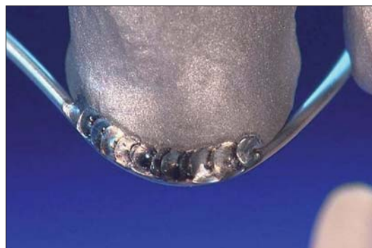
Abb. 3: Das phaser-Schweißen im Mikrobereich wurde weiter optimiert – Randkorrektur mithilfe eines 0,35mm starken Zulegdrahts.
