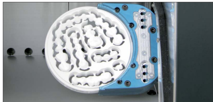
Die Systeme von Goldquadrat sind mit einer intelligenten Blankhalterung ausgestattet.
