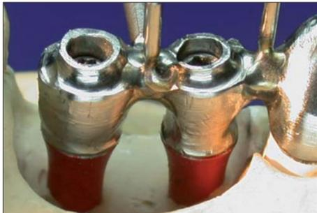
Abb. 5: Mit den phaser-Geräten lassen sich auch komplexe Implantatarbeiten perfekt schweißen.
