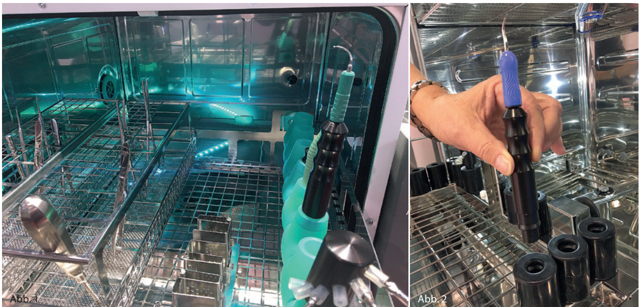
Abb. 1 und 2: Aufnahmevorrichtung für den Cavitron® Insert Adapter am Beispiel eines IC Medical Thermodesinfektors.
