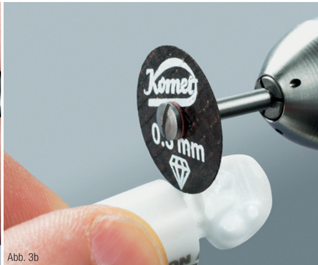
Abb. 3a und b: Das Set integriert alle rotierenden Werkzeuge für das Ausarbeiten einer vollkeramischen Restauration – vom Abtrennen bis zur Politur.
